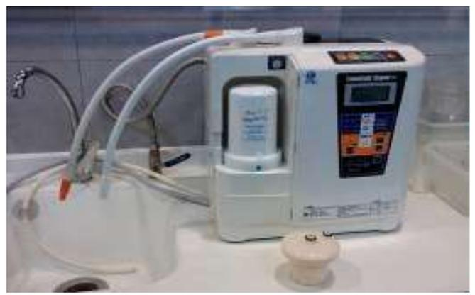
7. 裝回黑色蓋，插回電源，清洗完畢。E-cleaning 只能清先還原水側電解槽，強酸性水電解槽的清洗只能按清洗按鈕或使用電動水泵進行。
